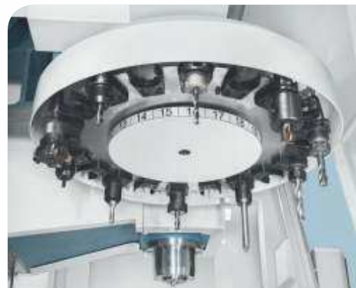
Cambiador automático de herramientas con capacidad para 20 herramientas (ROMI D 600)
